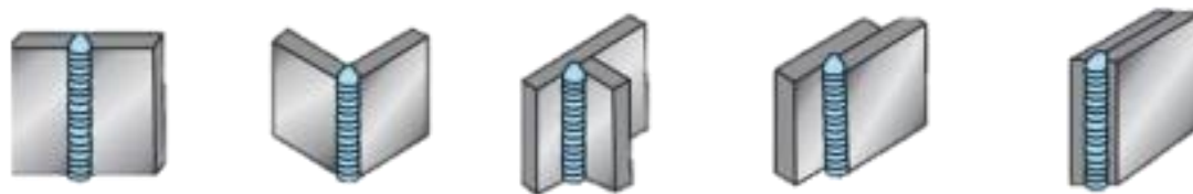
ภาพที่ 2-8 แสดงลักษณะตำแหน่งการเชื่อมท่าตั้ง
