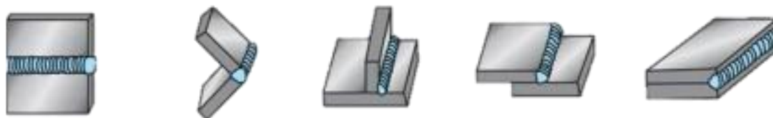
ภาพที่ 2-7 แสดงลักษณะตำแหน่งการเชื่อมทำขนานนอน
