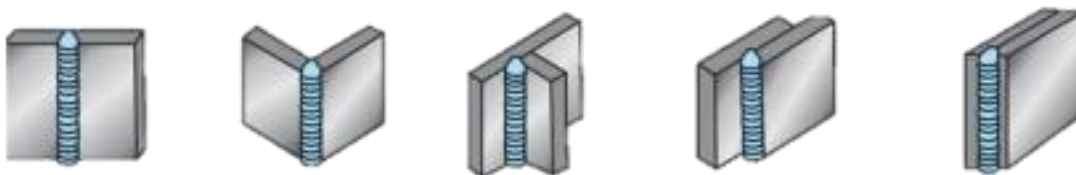
ภาพที่ 2-8 แสดงลักษณะตำแหน่งการเชื่อมทำตั้ง
