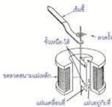
รูปที่ 3.10 โครงสร้างเครื่องวัดแบบแผ่นเหล็กเคลื่อนที่ชนิดหลัก
