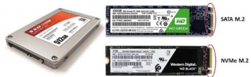
แสดง SSD แบบเชื่อมต่อด้วยสาย และแบบเป็นแผงเสียบ
