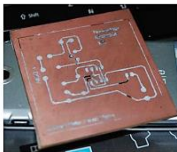
รูปที่ 1.18 แสดงแผงหมึกที่ติดอยู่กับแผ่นวงจรพิมพ์ด้านทองแดง
