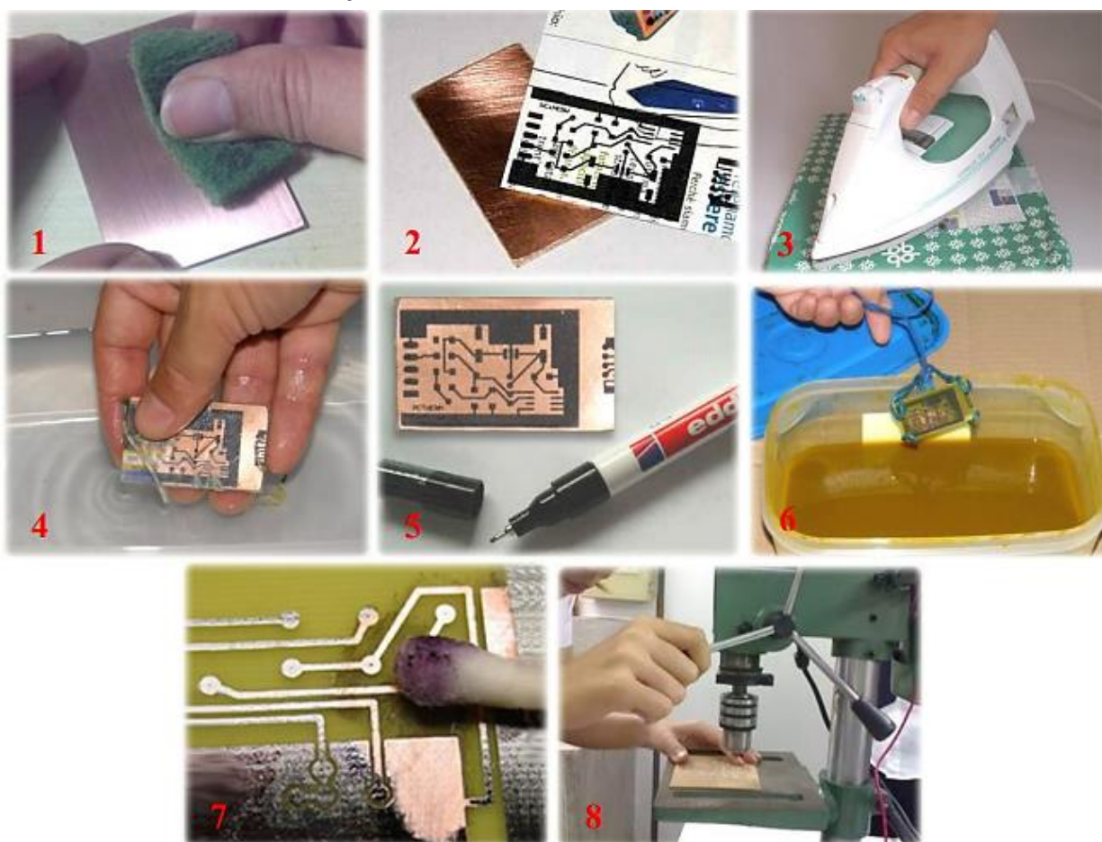
รูปที่ 17.5 แสดงขั้นตอนการสร้างแผ่นวงจรพิมพ์
