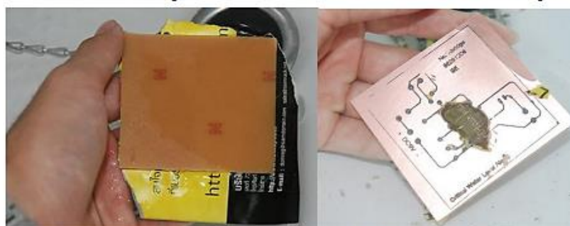
รูปที่ 1.17 แสดงการนำแผ่นที่รีดไปล้างน้ำ
