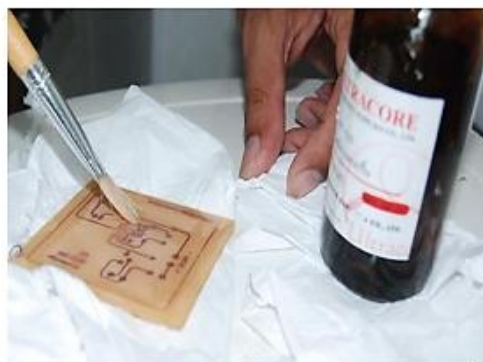
รูปที่ 1.21 แสดงการใช้น้ำยาเคลือบแผ่นปริ้นท์
