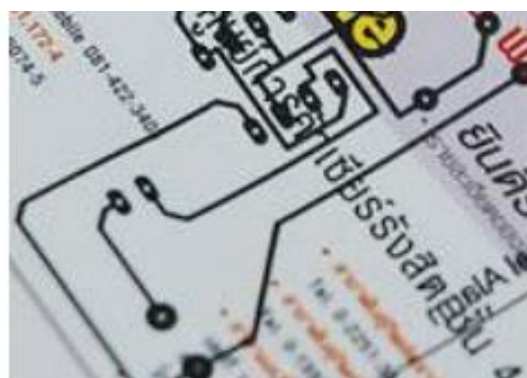
รูปที่ 1.14 แสดงวงจร PCB Layout ที่ พิมพ์ด้วยเครื่องปริ้นเตอร์
