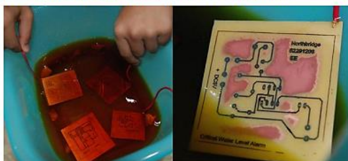
รูปที่ 1.19 แสดงขั้นตอนการผสมกรดกัดปริ้นท์กับน้ำ
