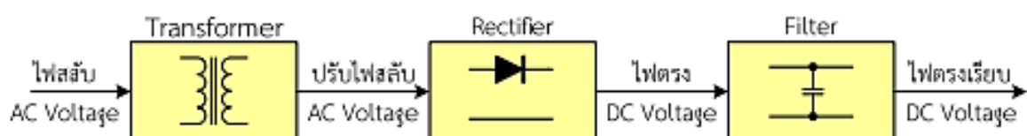
รูปที่ 2.7 บล็อกไดอะแกรมแหล่งจ่ายไฟตรงแบบใช้คาปาซิเตอร์เป็นตัวกรองพร้อมสัญลักษณ์
