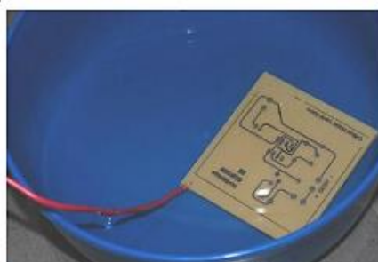
รูปที่ 1.20 แสดงการล้างแผ่นปริ้นท์ด้วยน้ำสะอาด
