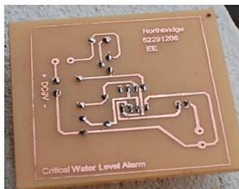
รูปที่ 1.22 แสดงวงจรพิมพ์ หรือ แผ่นปริ้นท์ประเภท Single Sided Boards ที่สมบูรณ์
