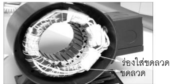
รูปที่ ๕.๙ แสดงโครงสร้างของสเตเตอร์และขดลวดที่พันอยู่ที่สเตเตอร์
