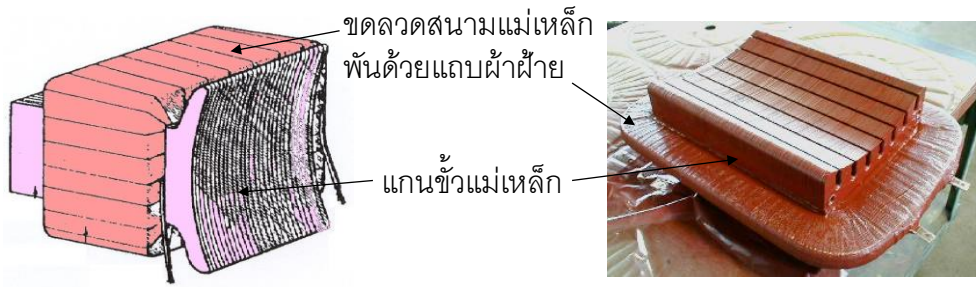
(ก) ภาพลายเส้นของแกนขั้วและขดลวดสนามแม่เหล็ก (ข) ภาพจริงของแกนขั้วและขดลวดสนามแม่เหล็ก
