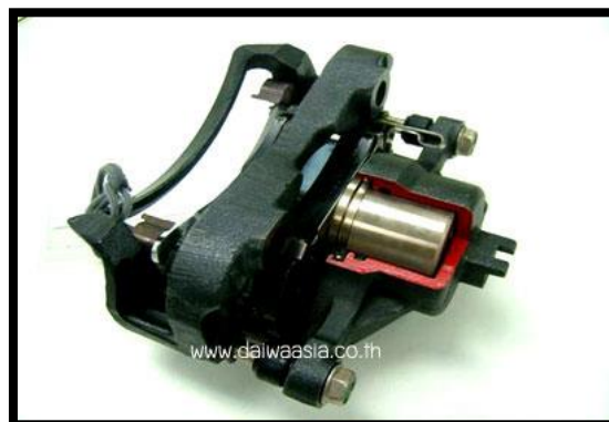
ตัดขวางแสดงลักษณะของลูกสูบเบรก
