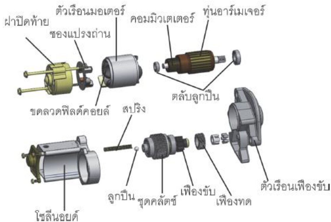
รูปที่ 5.19 ส่วนประกอบของมอเตอร์แบบทดรอบ
