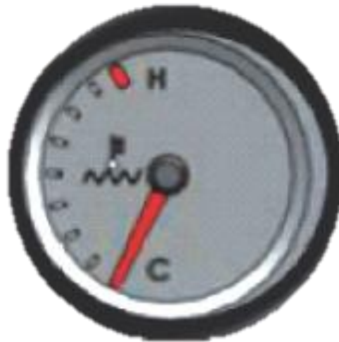
รูปที่ 10.7 เกจวัดอุณหภูมิน้ำหล่อเย็น
