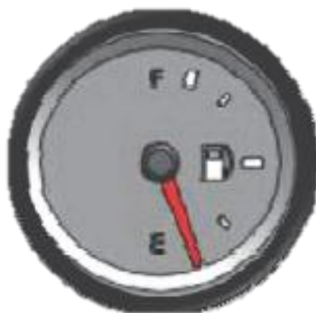
รูปที่ 10.11 เกจระดับน้ำมันเชื้อเพลิง
