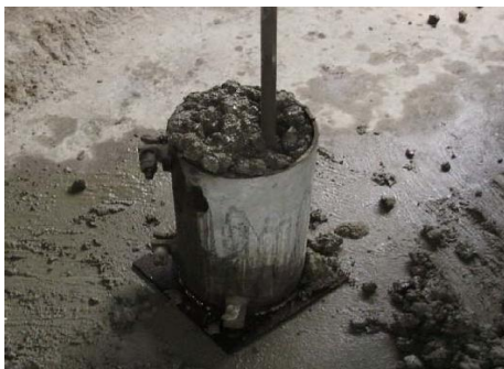
รูปที่ 1 การหล่อแท่งคอนกรีตโดยใช้เหล็กกระทุ้ง
