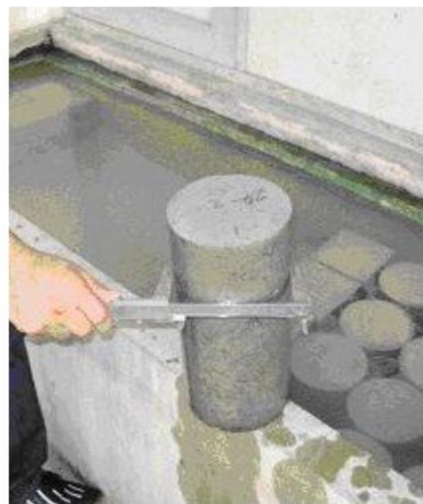
รูปที่ 2 วัดขนาดแท่งตัวอย่างรูปทรง ลูกบาศก์กระบอก
