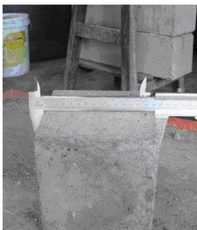
รูปที่ 1 วัดขนาดแท่งตัวอย่างรูปทรง
