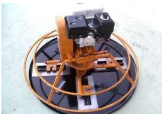
เครื่องขัดประกอบอุปกรณ์งานขัด ปรับระดับ
