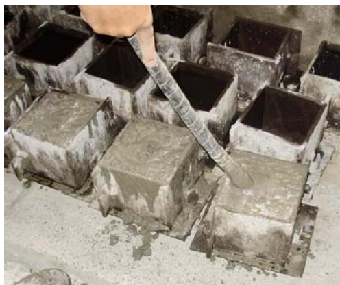
รูปที่ 2 การหล่อแท่งคอนกรีตโดยใช้เครื่องสั่นคอนกรีตชนิดจุ่ม
