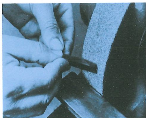
รูปที่ 5.14 แสดงการลับมุมเอียงคมตัดพร้อมทั้งลับมุมหลบข้าง
