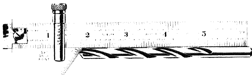
รูปที่ 5.7 วิธีการวัดมุมและวัดความยาวคมตัดดอกสว่าน
