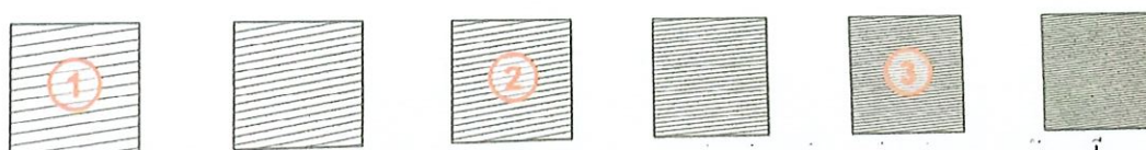
รูปที่ 4.15 ชนิดของพื้นตะไประแบ่งเป็น 3 ชนิด เปรียบเทียบกับแบบแบ่งเป็น 6 ชนิด
