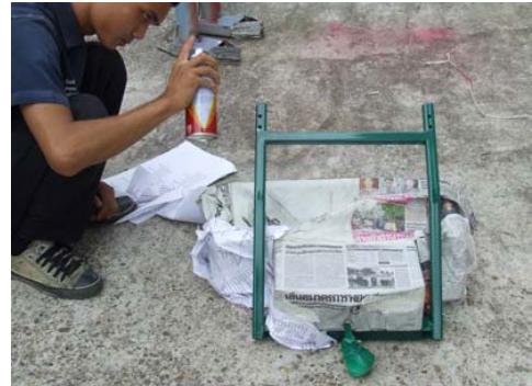
รูปที่ 3.4 แสดงการขัดละเอียดและพ่นสีตัวเครื่อง
