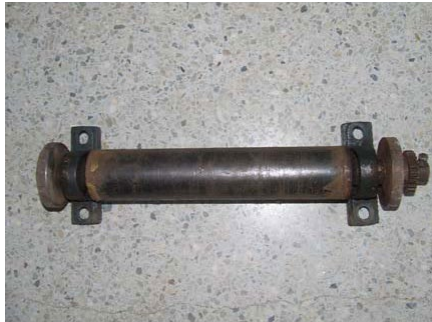
รูปที่ 3.3 แท่งแม่เหล็กทรงกระบอกยึดติดกับตุ้กดัดและฟันเฟือง
