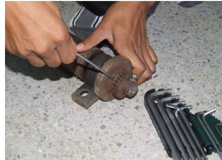
รูปที่ 3.3 แท่งแม่เหล็กทรงกระบอกยึดติดกับตุ้กดัดและฟันเฟือง
