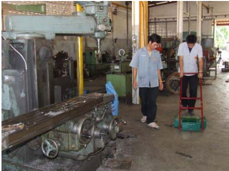
รูปที่ 3.11 แสดงการทดลองการใช้เครื่องดูดเศษโลหะที่ร้านโรงกลึงเหล็ก
