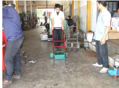
รูปที่ 3.11 แสดงการทดลองการใช้เครื่องดูดเศษโลหะที่ร้านโรงกลึงเหล็ก
