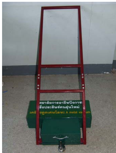
รูปที่ 3.7 ภาพเครื่องคูดเศษโลหะที่เสร็จสมบูรณ์
