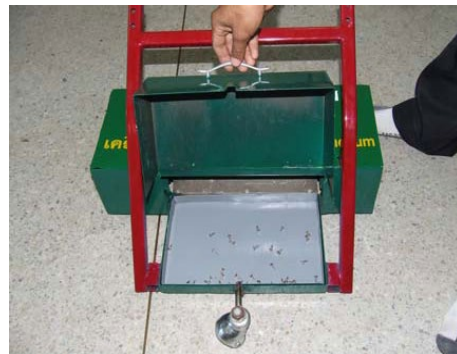
รูปที่ 3.8 แสดงตัวอย่างการทดลองการใช้เครื่องดูเศษโลหะ
