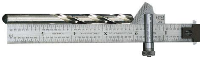
รูปที่ ๔.๒๑ เกจวัดมุมและการวัดมุมดอกสว่าน (ที่มา : สงวน ศรีราม.๒๕๕๑)
