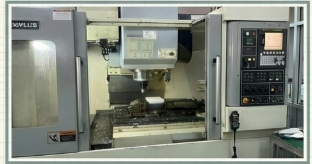
การกัดขึ้นรูปชิ้นงานจริง ที่เกิดจ จากการเขียนโปรแกรมร่วมกันของกลุ่ม
