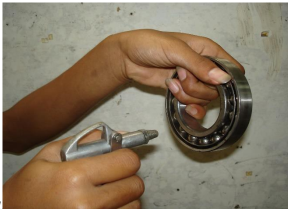
รูปที่ 4-33 ให้ใช้มือจับแหวนนอก-ในของเบร้งให้แน่น (อย่าให้หมุน)
