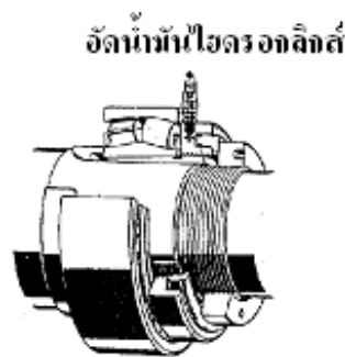
รูปที่ 4-24 การใช้้ำมันไฮดรอลิกส์ดันนัตวงแหวนบนเพลลา
