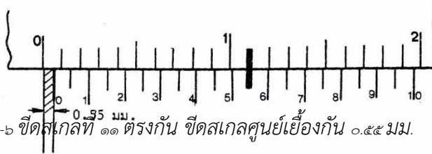
ภาพที่ ๑-๖ ขีดสเกลที่ ๑๐ ตรงกันขีดสเกลศูนย์เยื้องกัน ๐.๕ มม.
