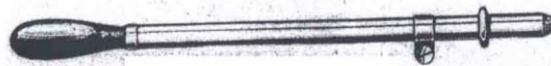
รูปที่ ๒.๑๔ ตัวแต่งหน้าหินเจียรระไน (Abrasive Stick Wheel Dressing Tool)
