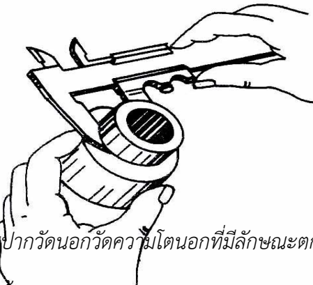
ภาพที่ ๑-๑๒ วิธีใช้เวอร์เนียคาลิปเปอร์วัดขนาดงาน
