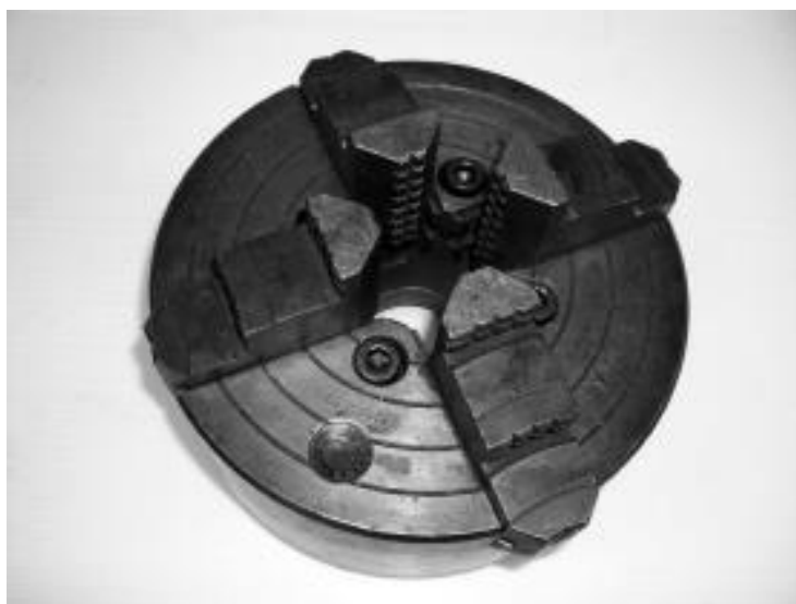
ภาพที่ ๖.๑๐ หัวจับแบบสี่จับอิสระ
