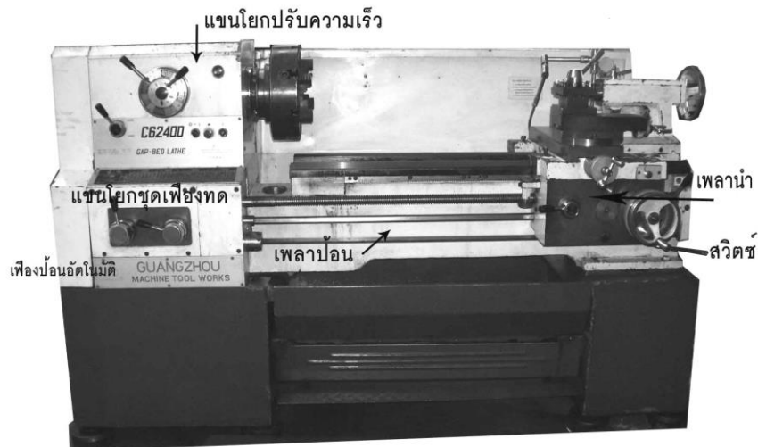
ภาพที่ ๖.๔ ส่วนประกอบของชุดระบบป้อน
