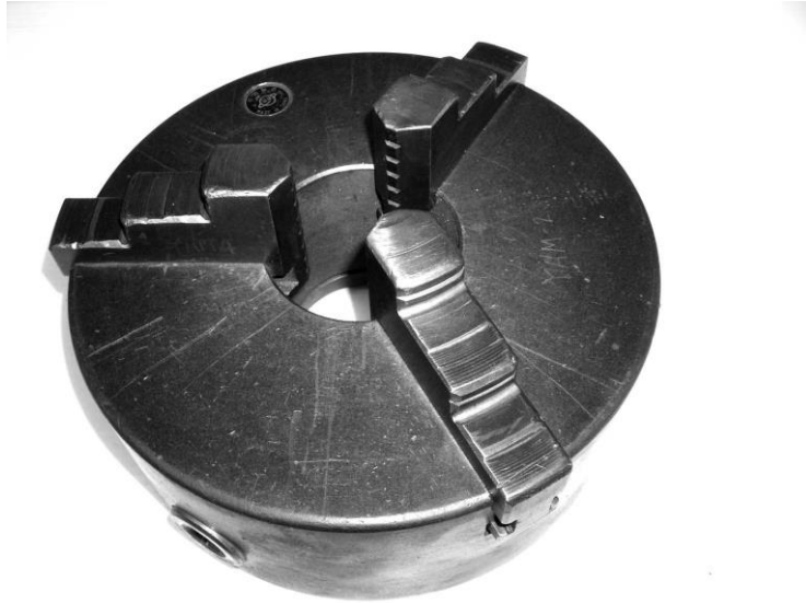
ภาพที่ ๖.๙ หัวจับแบบสามจับพร้อม
