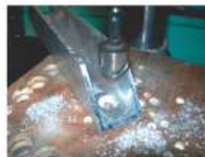
ข) ลักษณะการทำงานของดอกผายปากรู
