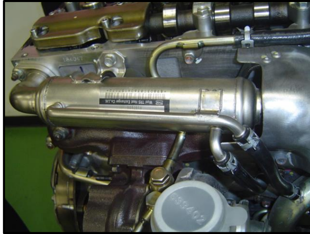
รูปที่ 1.15 แสดงตำแหน่งการติดตั้งวาล์วควบคุมไอเสีย ที่มา : นายขจรศักดิ์ ธัญเมธารัตน์
