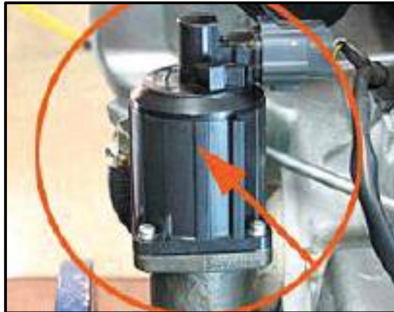
รูปที่ 1.16 แสดงตำแหน่งการติดตั้งวาล์วควบคุมไอเสีย ที่มา : นายขจรศักดิ์ ธัญเมธารัตน์
