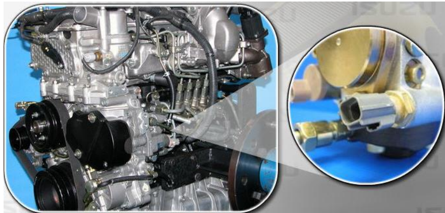
รูปที่ 1.7 แสดงตำแหน่งการติดตั้ง ตัวรับรู้อุณหภูมิน้ำมันเชื้อเพลิง ที่มา : นายจรศักดิ์ ธัญเมธารัตน์
